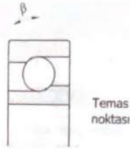
Şekil 26.4 Bir eğik bilyalı yatakta basınç (yük) açısı (β)
