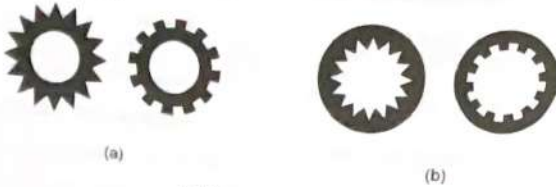
Şekil 21.39 Kavrama lamelleri a. dış lameller b. iç lameller
